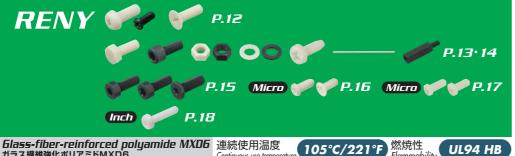
RENY(レニー)はポリアミドMXD6をベースポリマーとし、ガラス繊維50%で強化した結晶性のエンジニア リングプラスチックです。エンジニアリングプラスチックの中で最も大きい強度・弾性率を有し耐油性や耐熱性 にも優れることから、金属の代替材料として自動車等輸送機部品・一般機械・精密機械部品・電気・電子機械 部品・土木建築用部材などに用いられています。
